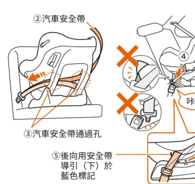
3 ①從靠近車門的一側拉出肩帶。②當打開車門一側鎖定裝置時，將汽車肩帶塞到鎖定裝置。③在將安全座椅主體推向汽車座椅的同時，用力拉出汽車肩帶以收緊腰帶。
