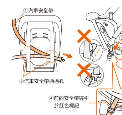
3 ①從靠近車門的一側拉出肩帶。②當打開車門一側鎖定裝置時，將汽車肩帶塞到鎖定裝置。③將汽車肩帶帶到座面中央，加以體重令幼童保護裝置更加緊貼汽車座席。
