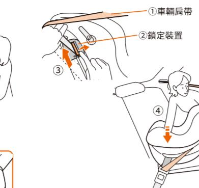
4 ①拉出汽車肩帶。②將安全帶上部塞入安全帶導引。③推動並閉合鎖定裝置。
